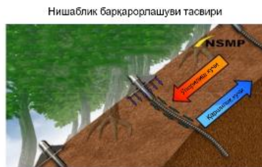
12-расм. Нишаблик турғунлигини мустаҳкамлаш учун «решоткасиз услуб».
