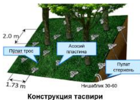
12-расм. Нишаблик турғунлигини мустаҳкамлаш учун «решоткасиз услуб».
