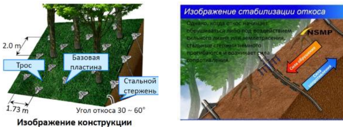
Рис. 12. «Нерешёточный метод» укрепления устойчивости склонов.
