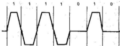
Рисунок 1. Биполярное кодирование
