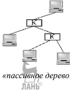
Рисунок 61. Топология «пассивное дерево». К — концентраторы
