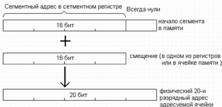
Рисунок 42. Образование физического адреса из сегментного адреса и смещения
