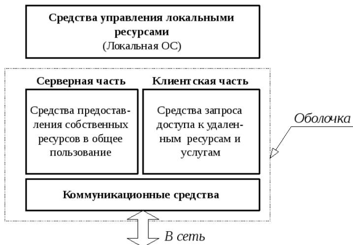
Рисунок 49. Структура сетевой операционной системы
