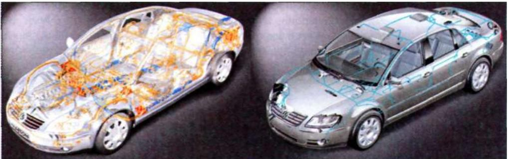
**Рис. 2.125. Сравнение автомобилей с разными типами электропроводки. Применение мультиплексных линий дает возможность существенно упростить электропроводку**
