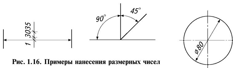
Рис. 1.16. Примеры нанесения размерных чисел
