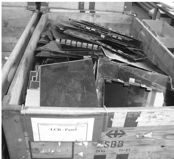
Рис. 3.17. Вышедшие из строя ЖК-дисплеи
