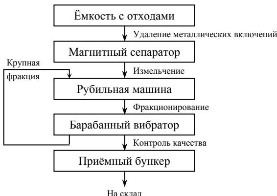
Рис. 4.2. Технологическая схема производства щепы
