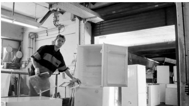
**Рис. 3.23. Извлечение внутренних съёмных частей холодильника**
