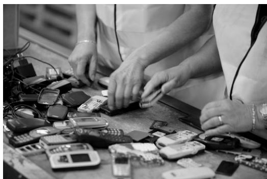
Рис. 3.30. Ручная разборка сотовых телефонов
