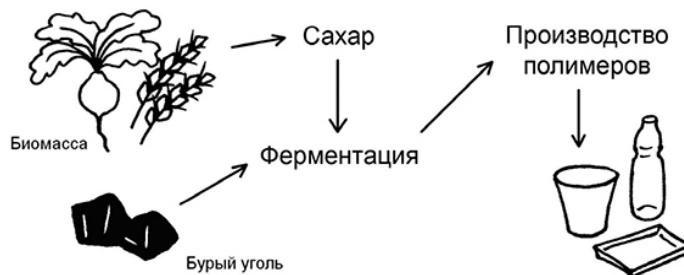
Рис. 6.5. Схема получения биоразлагаемого полимера
