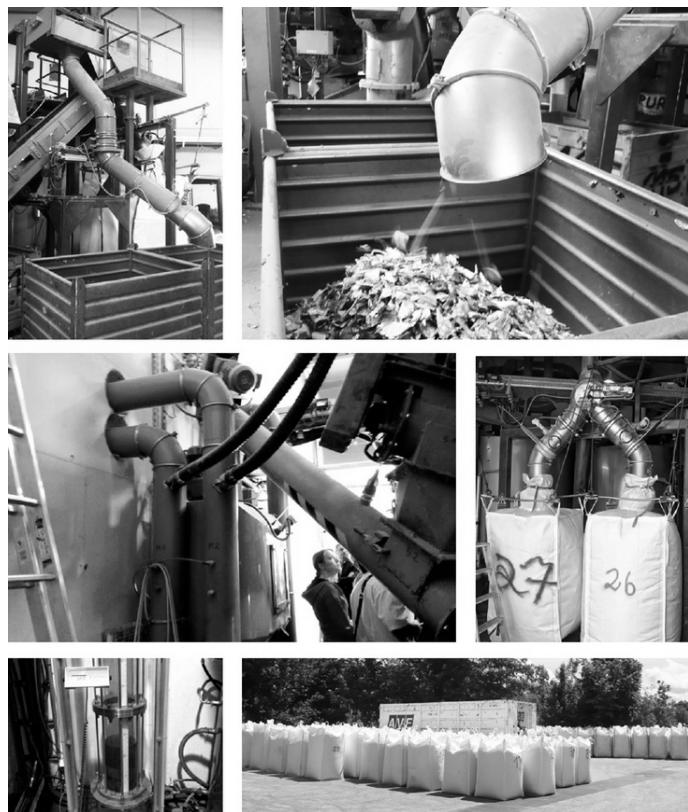
**Рис. 3.26. Процесс измельчения корпуса холодильника**
