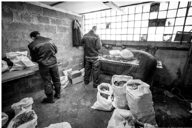
Рис. 3.10. Фото извлечения отдельных комплектующих компьютерной техники
