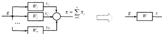
Рис. II.3. Передаточная функция параллельного соединения звеньев
