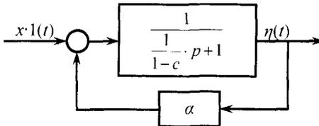
Рис. 3.5. Структурная схема замкнутой системы, полученной при включении мультипликатора в контур обратной связи
