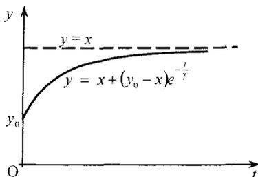
Рис. 3.2. Переходный процесс освоения производственных мощностей
