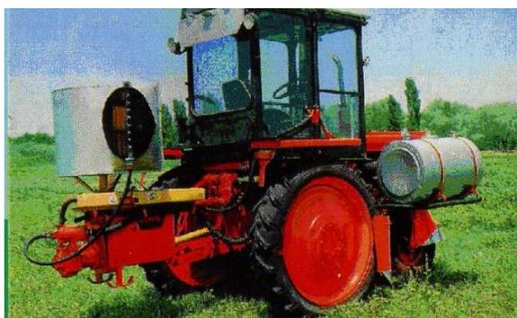
Рис.1.14. Опрыскиватель хлопковый марки КП-40
