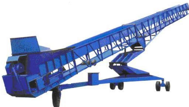
Рис.12.2. Конвейер ленточный КЛП-650
