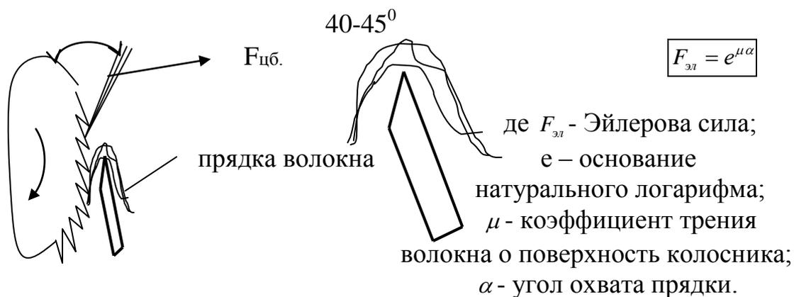
Рис.9.6. Схема процесса очистки волокна
