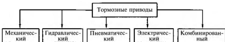
Рис. 13.11. Типы тормозных приводов
