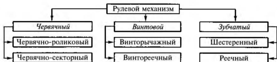
Рис. 12.7. Типы рулевых механизмов
