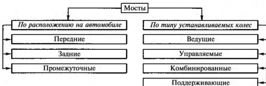
Рис. 9.1. Типы мостов автомобилей, классифицированных по различным признакам
