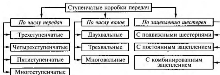
Рис. 3.4. Типы ступенчатых коробок передач, классифицированных по различным признакам
