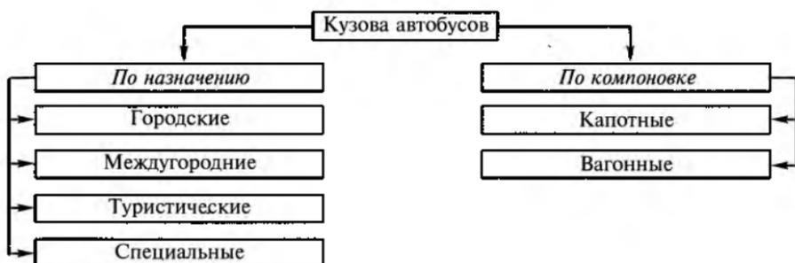
Рис. 14.15. Типы кузовов автобусов, классифицированных по различным признакам
