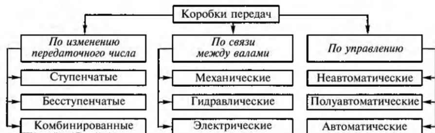
Рис. 3.1. Типы коробок передач, классифицированных по различным признакам
