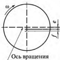
Рис. 5.12. Схема для определения критической частоты вращения карданного вала
