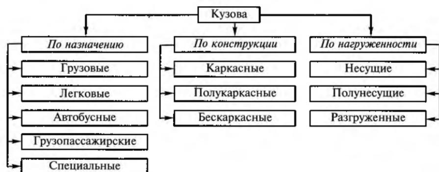
Рис. 14.10. Типы автомобильных кузовов, классифицированных по различным признакам
