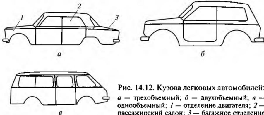
Рис. 14.12. Кузова легковых автомобилей: а — трехобъемный; б — двухобъемный; в — однообъемный; 1 — отделение двигателя; 2 — пассажирский салон; 3 — багажное отделение
