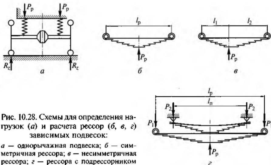
Рис. 10.28. Схемы для определения нагрузок (а) и расчета рессор (б, в, г) зависимых подвесок:
