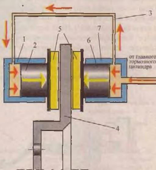
Рис. 54 Схема работы дискового тормозного механизма
