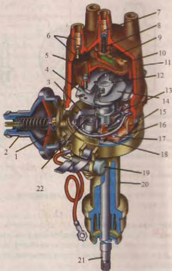
Рис. 20 Прерыватель распределитель.
