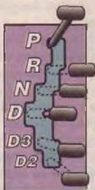
Рис. 39 Схема положения рычага селектора автоматической коробки передач
