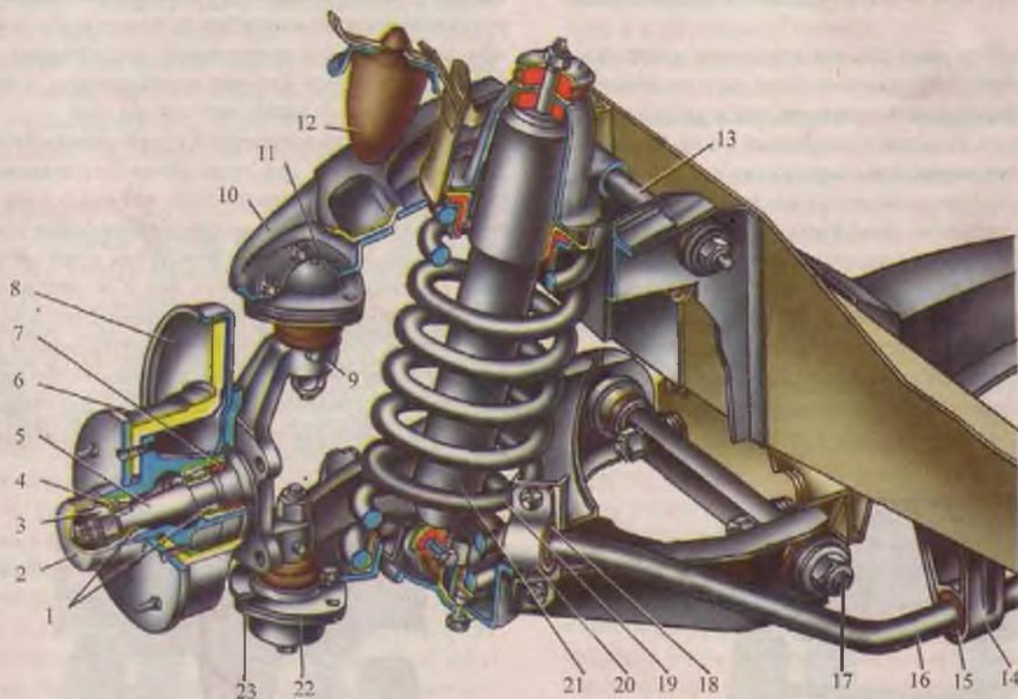
Рис. 43. Передняя подвеска, на примере автомобиля ВАЗ 2105
