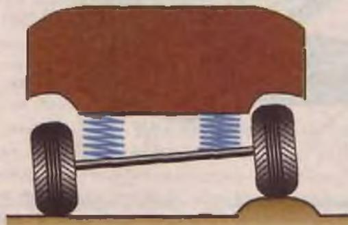
Рис. 40. Схема работы зависимой подвески колес автомобиля
