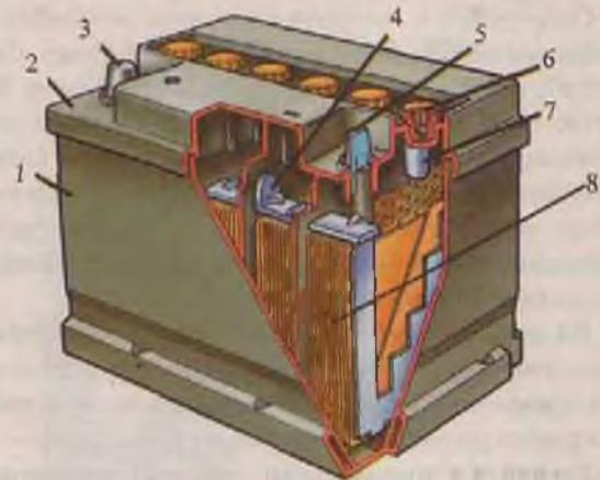
Рис. 57 Аккумуляторная батарея
