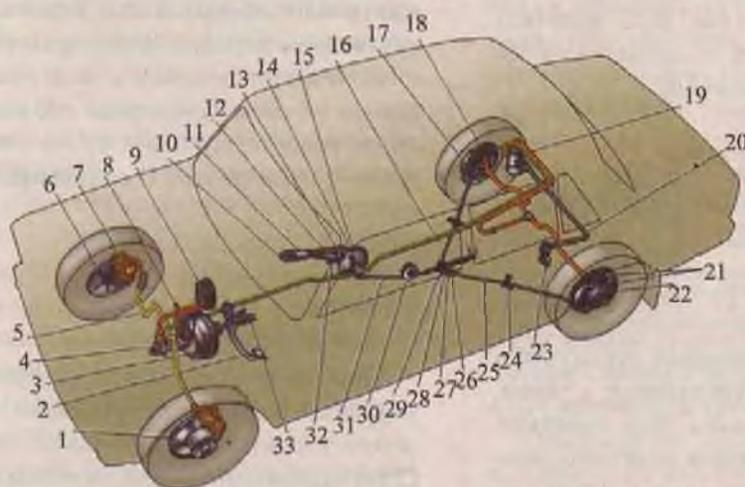
Рис. 50 Общая схема тормозной системы
