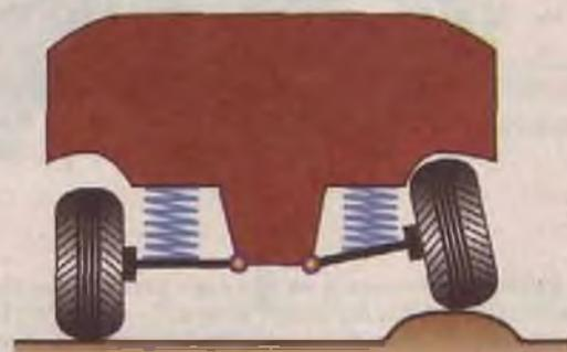
Рис. 41. Схема работы независимой подвески колес автомобиля
