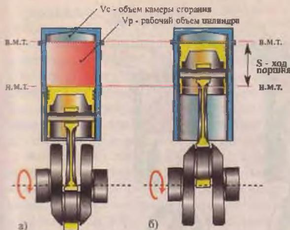
Рис. 7. Ход поршня и объемы цилиндра двигателя
