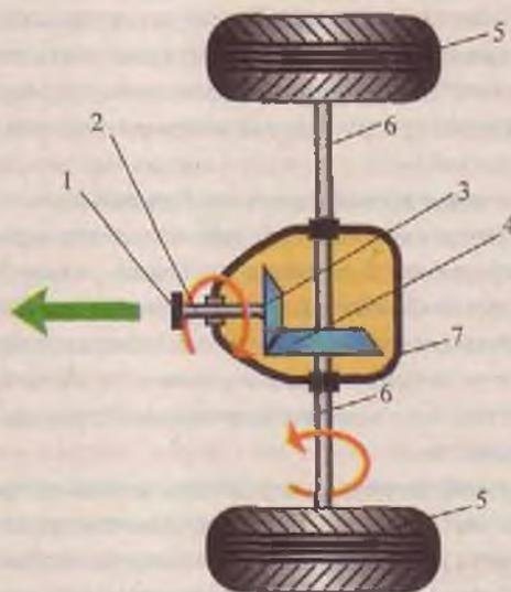
Рис. 37 Схема работы главной передачи
