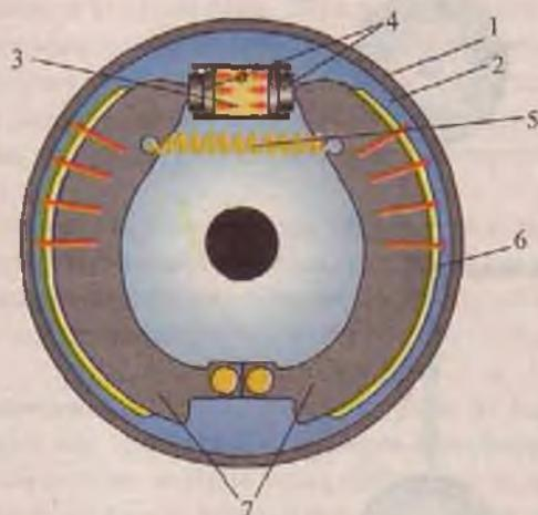
Рис. 53 Схема работы барабанного тормозного механизма
