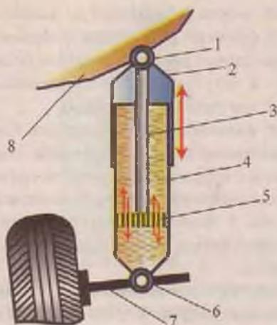
Рис. 42. Схема амортизатора
