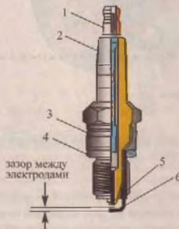
Рис. 23. Свеча зажигания
