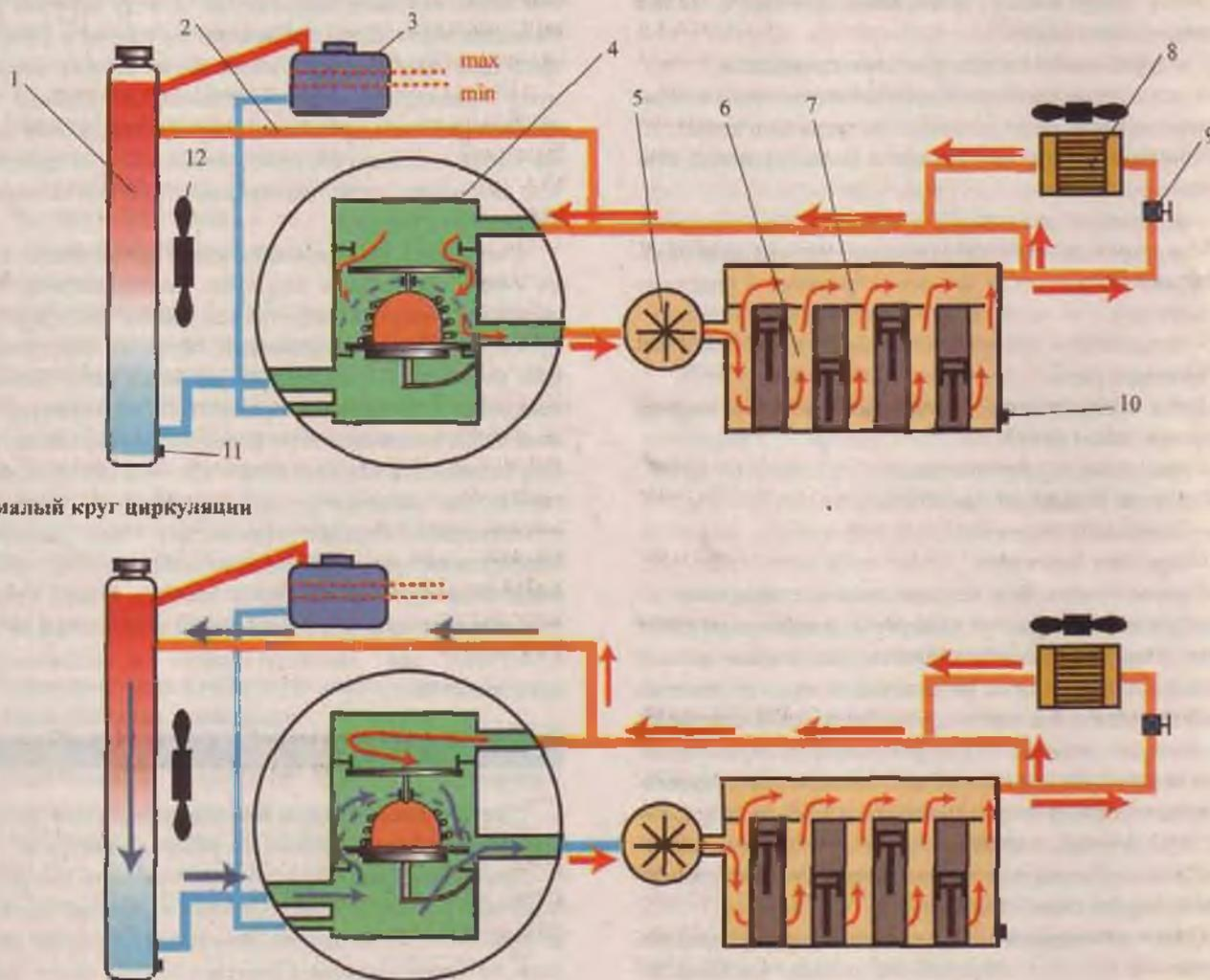
Рис. 25 Схема системы охлаждения двигателя
