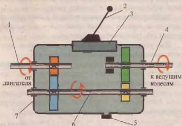
Рис. 34 Схема работы коробки передач.
