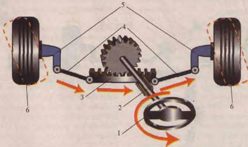
Рис. 48 Схема рулевого управления с механизмом типа «шестерня-рейка»
