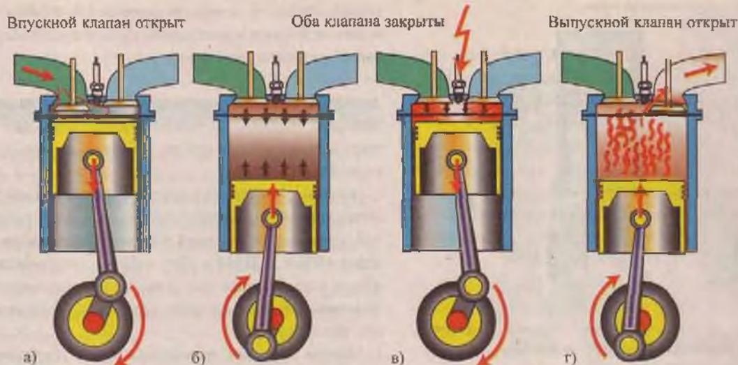
Рис. 8 Рабочий цикл четырехтактного карбюраторного двигателя
