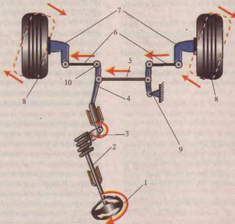
Рис. 47 Схема рулевого управления с механизмом типа «червяк-ролик»
