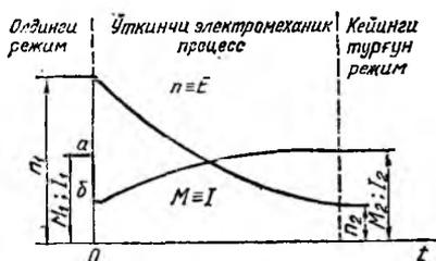
264-расм. Якорь занжирига қўшимча қаршилик киритиб двигателнинг айланиш частотасини ростлаш процесси. Бунда:  $R_{ю2} > R_{ю1}$ ;  $n_2 < n_1$ ;  $M_2 = M_1$ ;  $I_2 = I_1$ .
