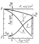
1, 2 - относительное сжатие  $\delta$  грунта с природной влажностью и в водонасыщенном состоянии в зависимости от давления; 3 - дополнительное относительное сжатие грунта в результате замачивания (относительная просадочность) при заданном давлении; 4 - зависимость относительной просадочности  $\delta_{n\,\mathrm{p}}$  от давления;  $P_{\mathrm{np}}$  - начальное просадочное давление
