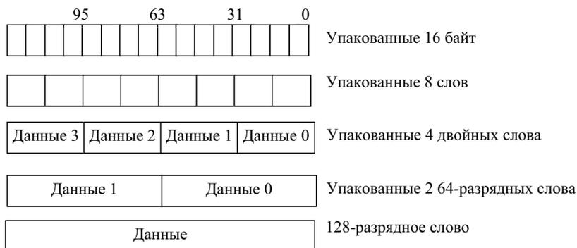
**Рис. 4.10.** Целочисленные данные SSE2 расширения
