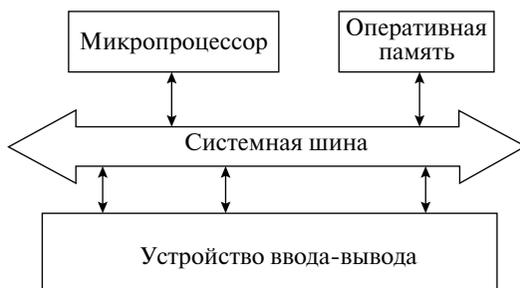
**Рис. 1.9.** Простейшая схема взаимодействия оперативной памяти с микропроцессором
