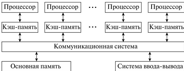
**Рис. 7.8.** Организация симметричной мультипроцессорной системы
