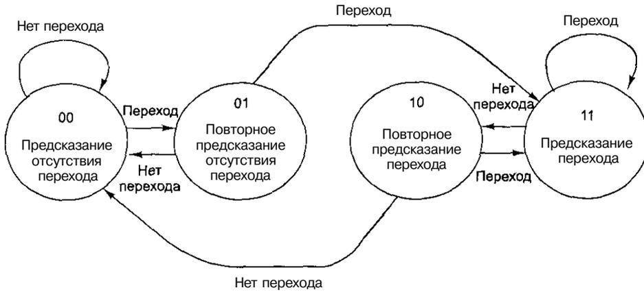
Рис. 4.29. Двубитный конечный автомат для прогнозирования переходов
