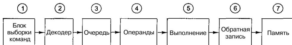
Рис. 4.24. Конвейер Mic-4
