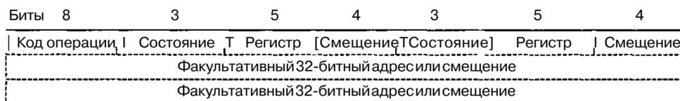
Рис. 5.17. Разработка форматов команд для двухадресной машины
