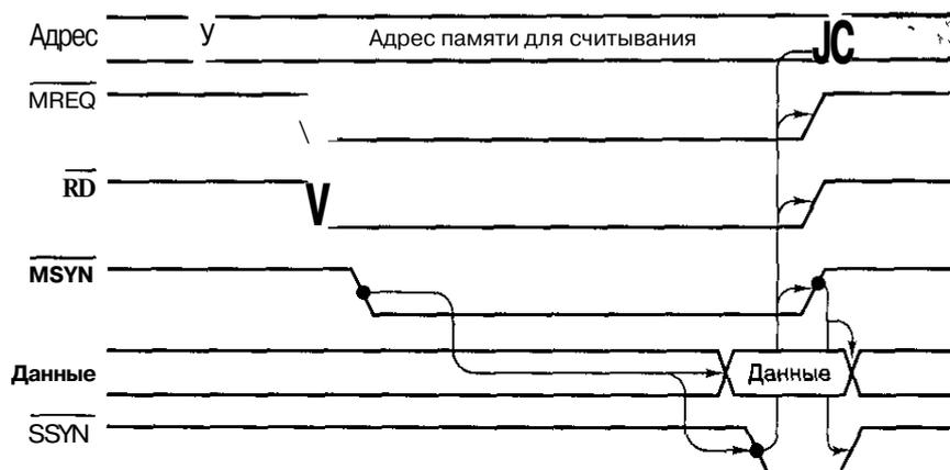
Рис. 3.35. Работа асинхронной шины
