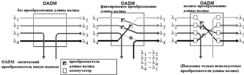
Рис. 6.16. Оптический мультиплексор ввода-вывода
