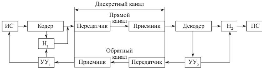
**Рис. 2.3.** Функциональная схема системы с РОС-ОЖ
