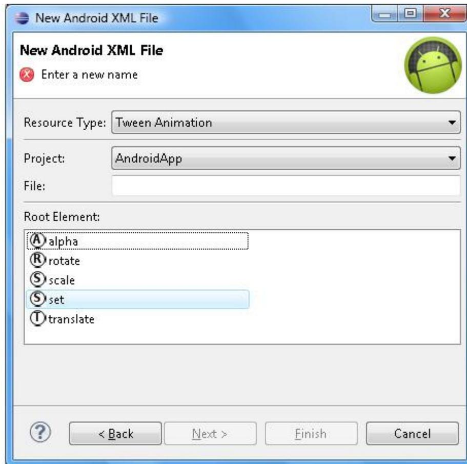
Поле **File**: мастера создания ресурса Tween Animation предлагает ввести имя нового файла XML-описания анимации, который затем с расширением .xml появится в каталоге res/anim Android-проекта и будет доступен в Java-коде с помощью сгенерированного класса R.anim.filename или в XML-коде с помощью ссылки @ [package: ] anim/filename.
