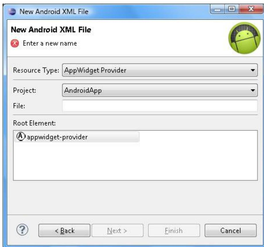
Поле **File:** мастера создания ресурса AppWidgetProvider предлагает ввести имя нового XML-файла метаданных приложения App Widget, который затем с расширением .xml появится в каталоге res/xml Android-проекта и будет доступен в XML-коде с помощью ссылки @ [package: ] xml/filename.
