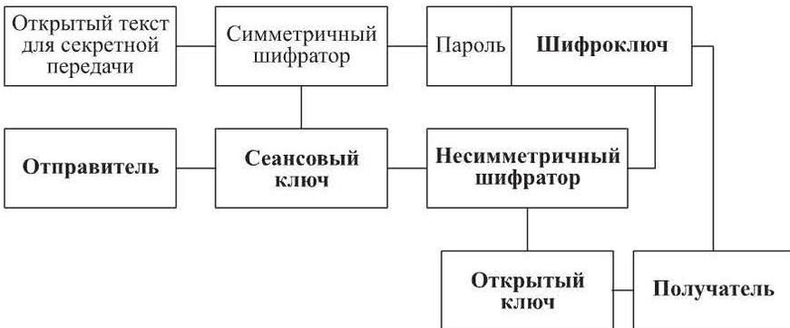
Рис. 12.6. Схема комбинированного шифрования
