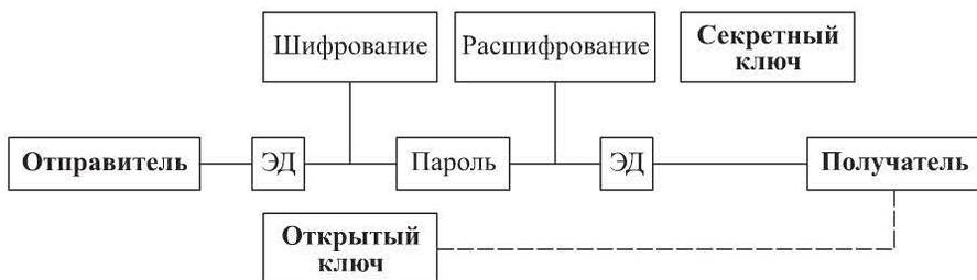
**Рис. 12.4.** Схема шифрования в криптографии с открытыми ключами
