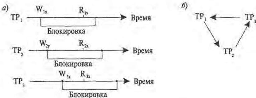
Рис. 4.12. Монополярная блокировка (тупик)
