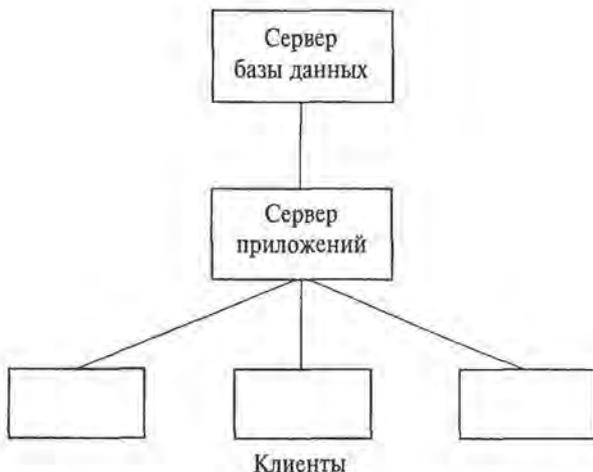
Рис. 15.7. Удаленный вариант режима клиент—сервер: многоуровневая структура
