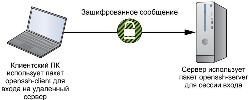
**Рис. 3.2.** Вход на удаленный сервер через зашифрованное соединение SSH
