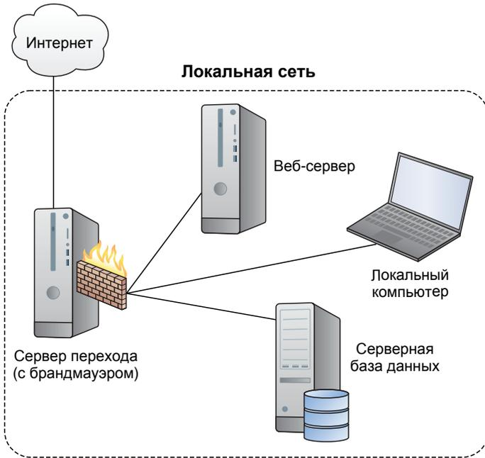
**Рис. 10.4.** Типичная архитектура сервера перехода
