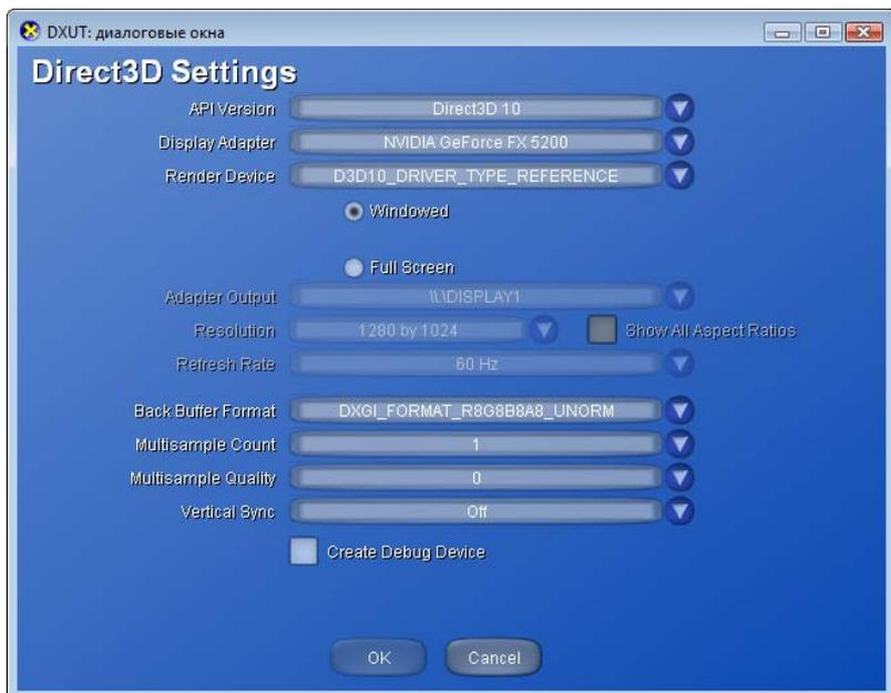
Рис. 12.4. Окно настройки параметров устройства Direct3D
