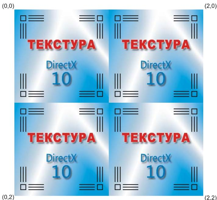
Рис. 7.16. Пример использования текстурных координат со значениями больше единицы
