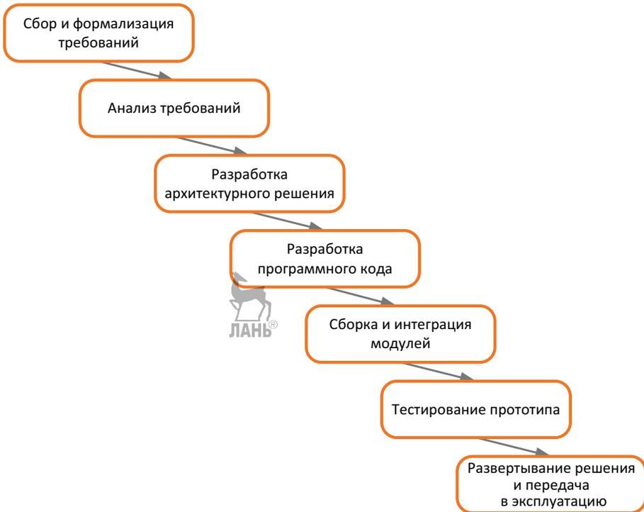
Рис. 1.3 ❖ Пример водопадной модели разработки программного обеспечения
