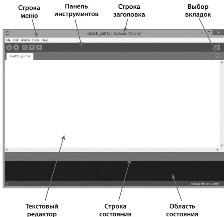
В сущности, интерфейс Arduino IDE похож на текстовый процессор. Он включает четыре главных раздела: строку меню, панель инструментов, текстовый редактор и область состояния.
