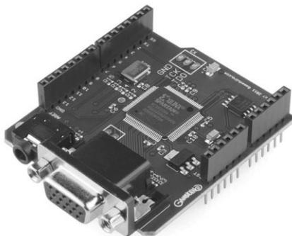
К другим возможностям шилда относится вывод видеоизображения в разрешении 400×300 пикселей, 15-битная внутренняя обработка цвета и символичный фон с разрешением 512×512 пикселей. Шилд поставляется в полностью собранном виде.
