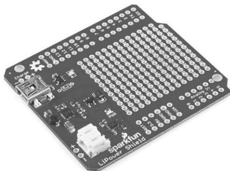
Проблема здесь состоит в том, что можно подключать только аккумуляторы с напряжением 3,7 В. Однако шилд LiPower позволяет поднять напряжение с 3,7 В до 5 В.
