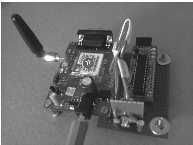
Она состоит из платы Arduino Uno, стандартного GSM/GPRS-модема на базе чипсета SIM900A и детектора проникновения (к примеру, инфракрасного
