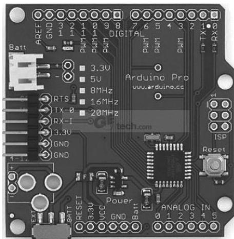
Arduino Pro предназначена для использования при полустационарной установке. На этой плате нет предустановленных колодок, что позволяет пользователю использовать все типы выводов и разъемов, необходимых для проекта, над которым он работает данный момент.
