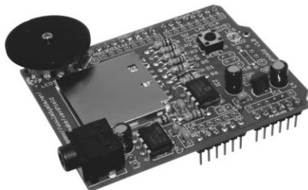
оборудован цифро-аналоговым преобразователем (ЦАП), фильтром и операционным усилителем для вывода качественного звука.
