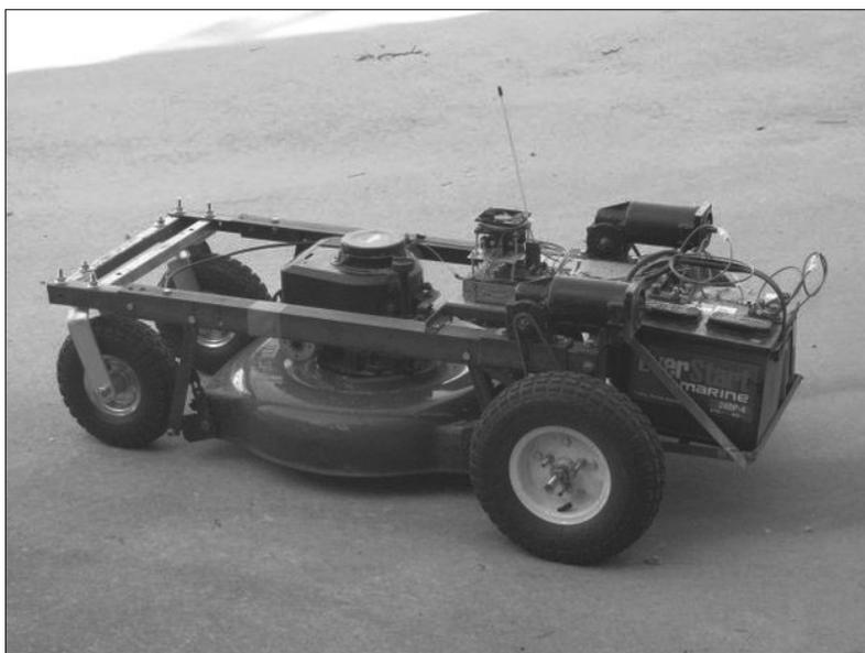
Металлический каркас и колеса — основная часть проекта. Конструкция требует хороших навыков работы с механикой, не говоря уже о необходимых инструментах. Здесь нет строгих и жестких правил — изобретательность будет вашим лучшим другом.
