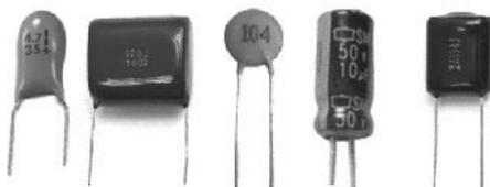
По сути, эти устройства состоят из двух проводящих пластин, разделенных диэлектриком.
