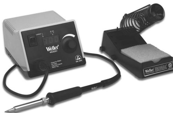
Станции хорошего качества оборудованы такими функциями, как микропроцессорный блок управления температурой, цифровая индикация температуры и автоматическое выключение.
