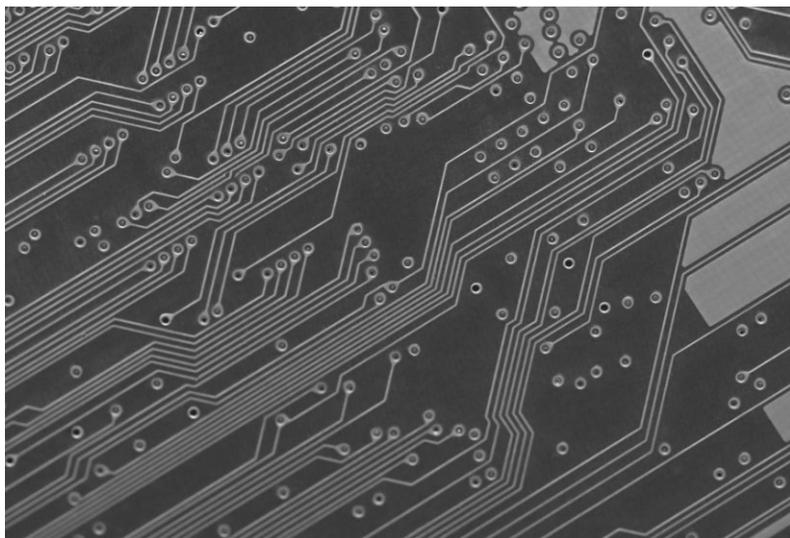
Просверленные в плате отверстия позволяют подключать компоненты к цепям, а затем припаявать их, создавая таким образом постоянное подключение.
