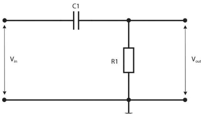
В фильтре такого типа ток проходит сначала через конденсатор, тогда как в низкочастотном фильтре ток сначала проходит через резистор.
