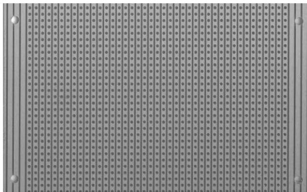
Через равные промежутки в плате просверлены отверстия, которые позволяют разместить входы и выходы компонентов на плате, а затем выполнить их пайку с обратной стороны. В углах платы расположены крепежные отверстия.
