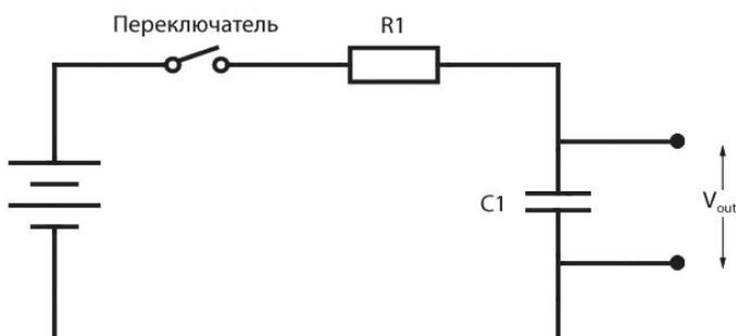
Когда переключатель замкнут, ток течет через резистор и начинает заряжать конденсатор. Пока конденсатор заряжается, он позволяет току протекать в цепь нагрузки ( $V_{out}$ ). Когда он полностью заряжен, движение тока в цепь нагрузки прекращается.
