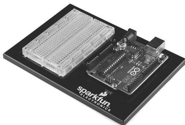
Выше приведен хороший пример. Панели такого типа имеют резиновое основание, которое предотвращает скольжение платы по рабочей поверхности.
