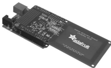
Шилд NFC обеспечивает вашу плату Arduino функциональностью NFC. Он не только может считывать NFC-теги, но и осуществляет запись на них.
