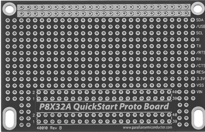
Протоплаты бывают различных форм и размеров, а также на одиночных, двойных и многослойных печатных платах. Вы можете приобрести протоплату такого же размера и компоновки, как ваша макетная плата Arduino.
