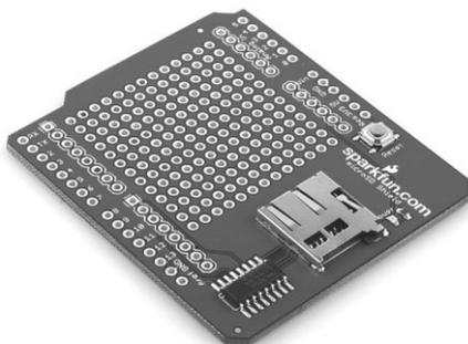
Шилд MicroSD позволяет решить эту проблему, обеспечивая вашу плату Arduino функциональными возможностями подключения устройства внешней памяти.
