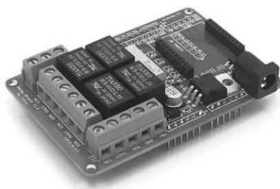
Реле — это однополюсный переключатель, что означает, что его можно использовать как нормально разомкнутое или нормально замкнутое реле.
