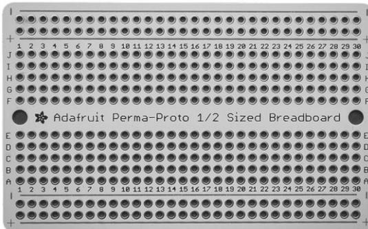
Протоплата типа Arduino
