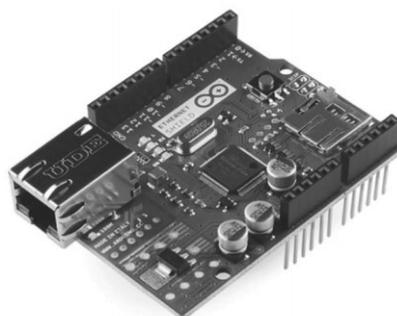
Этот шилд поддерживает до четырех одновременных подключений, которые соединяются с сетью через стандартный Ethernet-разъем RJ45.
