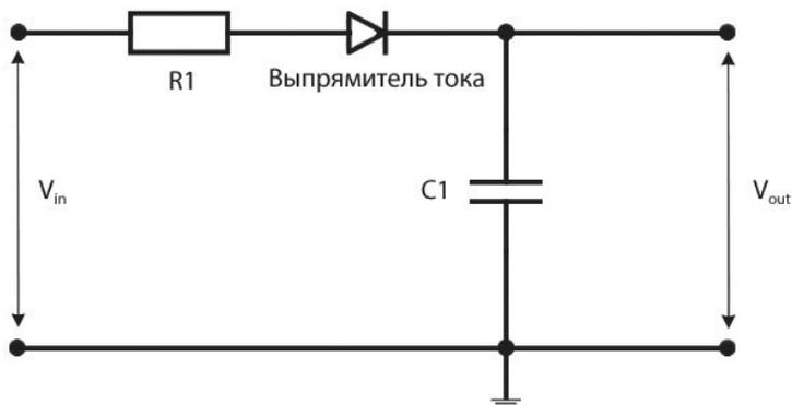
C1 — это сглаживающий конденсатор. Когда напряжение на выводе из выпрямителя растет, конденсатор заряжается. Когда напряжение на выводе выпрямителя падает, конденсатор разряжается, тем самым поддерживая течение тока. Форма колебаний входного и выходного сигнала показаны ниже.
