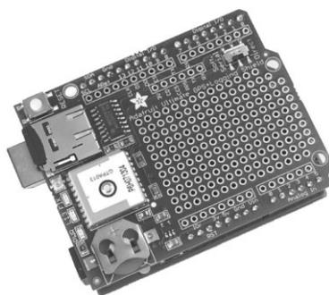
Просто подключите внешнюю GPS-антенну к шилду, и модуль задействует ее автоматически.
