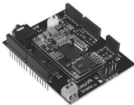
Этот шилд оборудован разъемом для подключения микрофона, аудиовыходом на колонки сопротивлением 8 Ом и аудиоразъемом TRS3,5 мм (mini-jack) для наушников. Также здесь присутствует программируемый светодиодный индикатор, предназначенный для обратной связи во время распознавания голоса.
