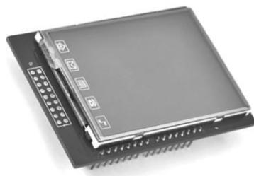
Размер экрана составляет 2,8 дюйма по диагонали, подсветка обеспечивается четырьмя светодиодными индикаторами, поддерживается разрешение  $240 \times 320$  и множество различных оттенков цвета.
