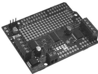
Для работы шилд Motor Shield R3 должен быть подключен к внешнему источнику электропитания, например адаптеру с напряжением 7–12 В.
