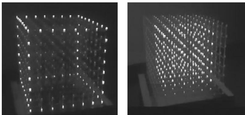
Светодиодный куб состоит из восьми слоев светодиодных индикаторов, расположенных на равном расстоянии и соединенных с помощью провода диаметром 0,22 мм. Благодаря пространству между светодиодными индикаторами, мы можем видеть их все на восьми слоях одновременно, что придает кубу эффект трехмерности.
