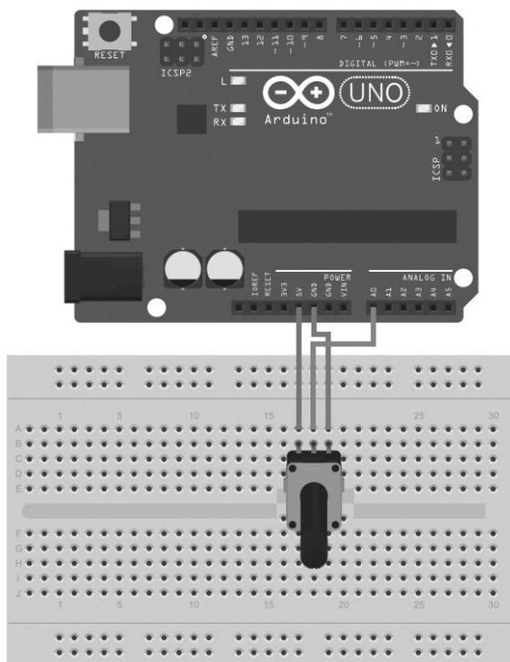
Подключите Arduino к компьютеру с помощью USB-кабеля, запустите интегрированную среду разработки Arduino и выберите команду меню **File** → **Examples** → **01.Basics** → **AnalogReadSerial** (Файл → Примеры → 01.Basics → AnalogReadSerial).
