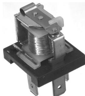
В процессе работы электромагнит заряжается от применения тока и создает магнитное поле. Затем магнитное поле притягивает якорь, который, в свою очередь, перемещает контакт, таким образом замыкая цепь.
