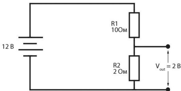
Принцип работы делителей напряжения очень прост. На схеме, изображенной выше, ток течет из батареи к резистору R1. В резисторе R1 10 В падают, оставляя 2 В на резистор R2. Так как выход берется с резистора R2, напряжение составит 2 В.
