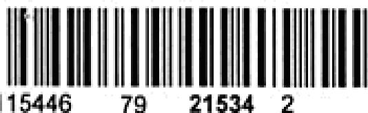
Pochta shtrix kodini bosib chiqarish uchun Interleaved 2 of 5 (EN 801) kodidan foydalaniladi. Shtrix-kod yorlig'inining o'lchami vertikal bo'yicha 15 mm va gorizontal bo'yicha 48 mm. Shtrix-kod o'lchami vertikal bo'yicha 9 mm va gorizontal bo'yicha 36 mm. Shtrix-kod ostidagi yozuv kodlangan qiymatga mos kelishi kerak.
