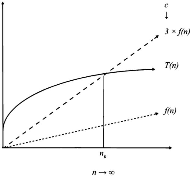
**Рис. 2.1.** Показывает, когда  $T(n) = O(f(n))$ . Константа  $c$  (равная 3 в данном примере) количественно иллюстрирует высказывание «постоянная кратная» от  $f(n)$ , а константа  $n_0$  количественно иллюстрирует высказывание «в конечном итоге»
