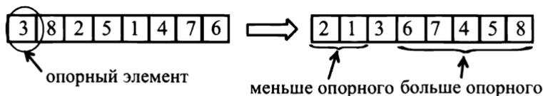
Этот пример ясно показывает, что элементы перед опорным не нужно размещать в правильном относительном порядке («1» и «2» инвертированы) и то же касается элементов после опорного. Эта подпрограмма разделения помещает (неопорные) элементы массива в два блока, один для элементов меньше опорного, а другой — для элементов больше опорного.
