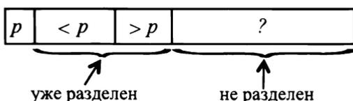
Таким образом, подпрограмма поддерживает следующий инвариант<sup>1</sup>: первым является опорный элемент; далее идут неопорные элементы, которые уже были обработаны, при этом все такие элементы меньше опорного предшествуют всем таким элементам больше опорного; затем в произвольном порядке идут еще не обработанные неопорные элементы.
