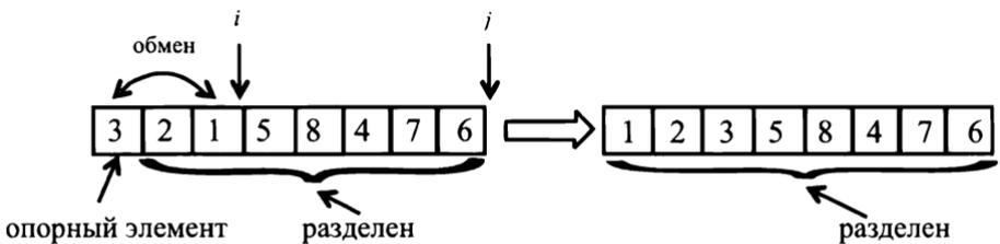
В соответствии с требованием в конечном массиве все элементы меньше опорного идут перед ним, и все элементы больше опорного идут после него. То, что «1» и «2» находятся в отсортированном порядке, является совпадением. Элементы после опорного, очевидно, находятся не в отсортированном порядке.
