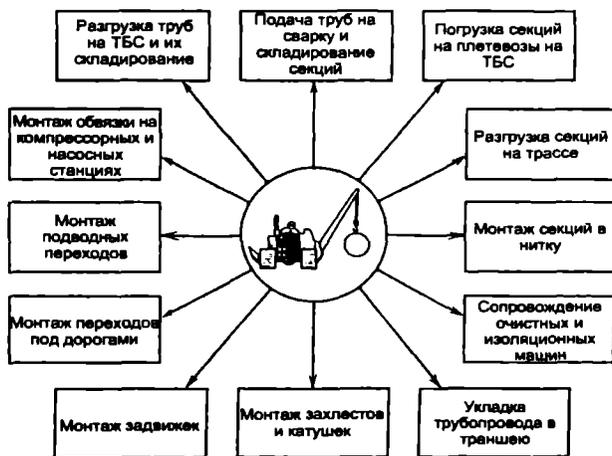
Рис. 21.74. Виды работ, выполняемых кранами-трубоукладчиками
