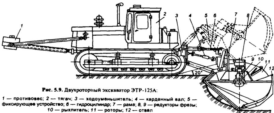
Рис. 5.9. Двухроторный экскаватор ЭТР-125А:
