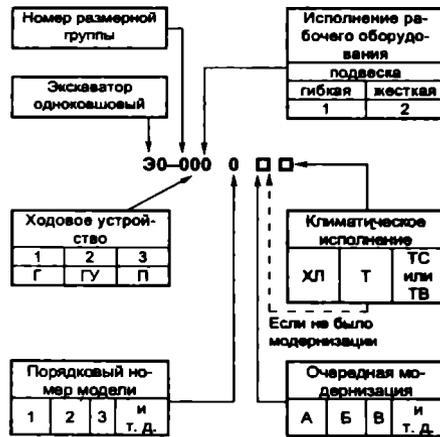
Рис. 4.5. Структура индекса универсальных одноковшовых экскаваторов
