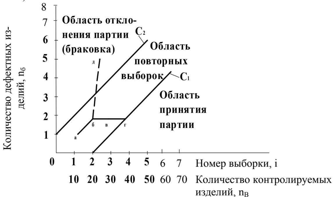
Рис. 10. Карта последовательного выборочного контроля
