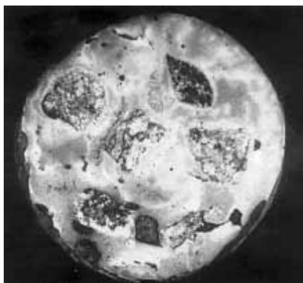
Рисунок 2.3- Микрошлиф для определения микротвердости гранитных зерен. После 24-х часовой выдержки изготавливали микрошлиф таким образом, чтобы на его поверхности находилось достаточное количество гранитных частиц (рис. 2.3), микротвердость которых измерялась на приборе ПМТ-3 при нагрузке 0,5 Н. Химический состав гранита. SiO-69...73%, Al2O3 -16...18%, CaO-1,75...26%, Fe2O3 <3,4%, P<0,10%, S<0,015%.
