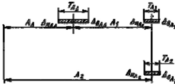
Рис.9.2. Размерная цепь и допуски, ограничивающие отклонения ее звеньев
